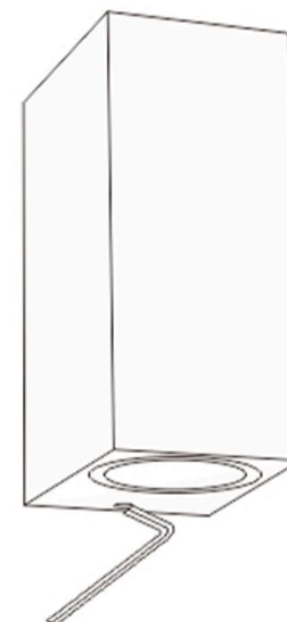
**3. Зафиксируйте винты с помощью небольшого гаечного ключа.**
